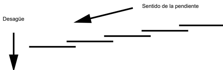
La soldadura entre los distintos paños de membranas se realizar con soplete de gas, con el que se calientan ambas superficies a soldar, lográndose la fusión total de ambos polietilenos de cobertura u la fusión de superficial de ambos asfaltos.
